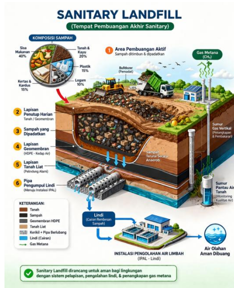
Gambar 16. teknologi sanitary landfill,
